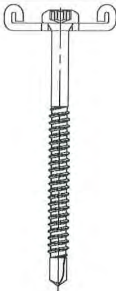
Bauder Befestigungsschiene 6/10, d = 6,5mm
